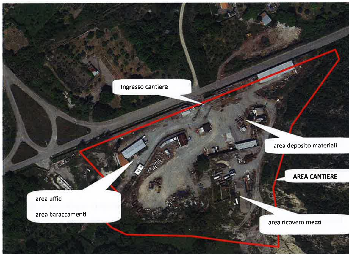
Disegno 3 – Ortofoto aerea cantiere Valsinni con indicazioni
